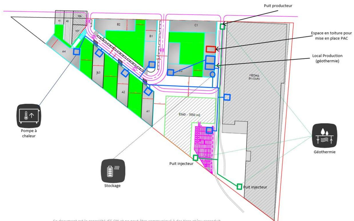
(14) Plan de principe de l'implantation des tuyauteries vers sous-stations
